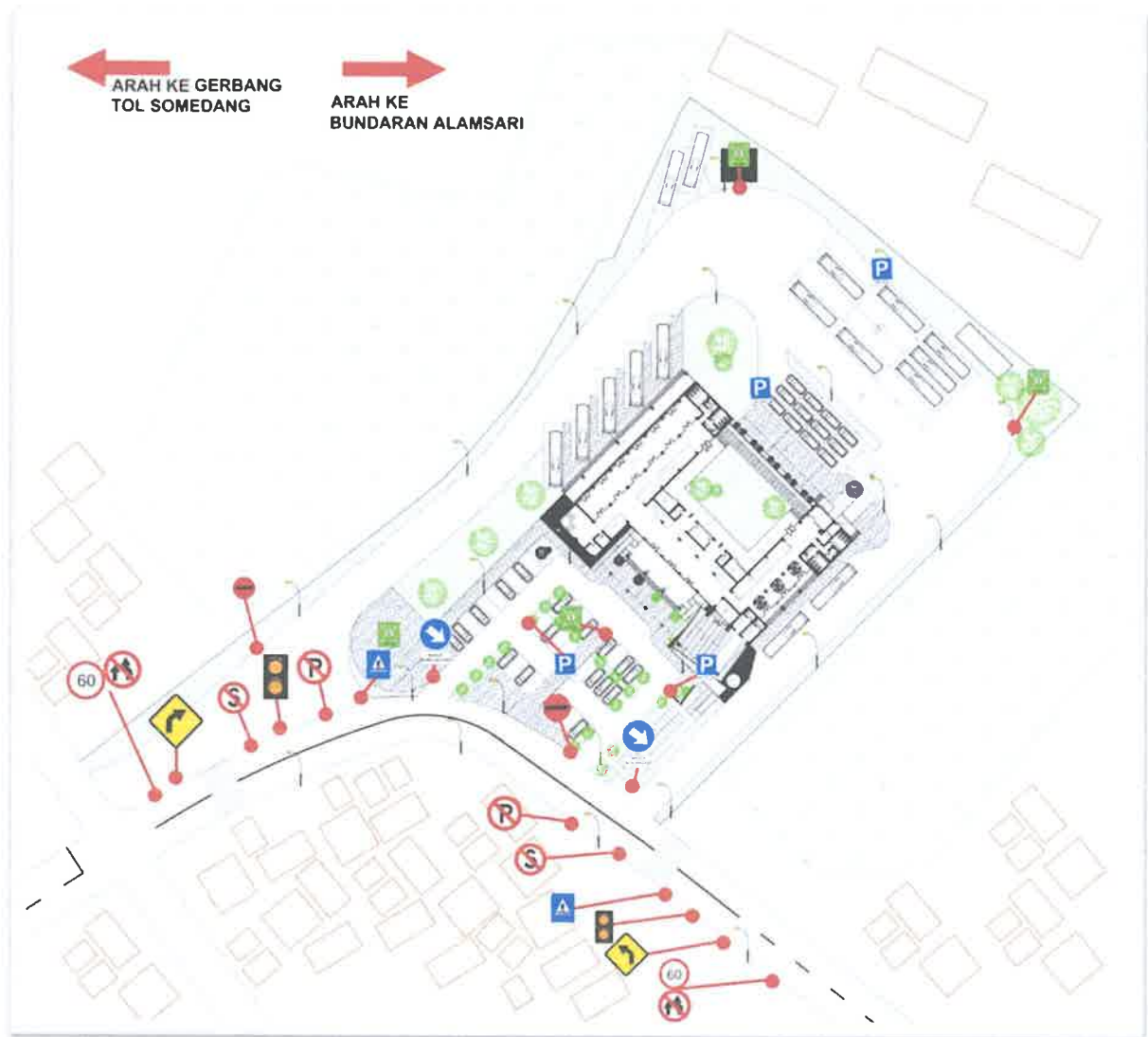
Gambar 5. 12 Titik Lokasi Pemasangan Lampu Penerangan Jalan & Lampu Peringatan
