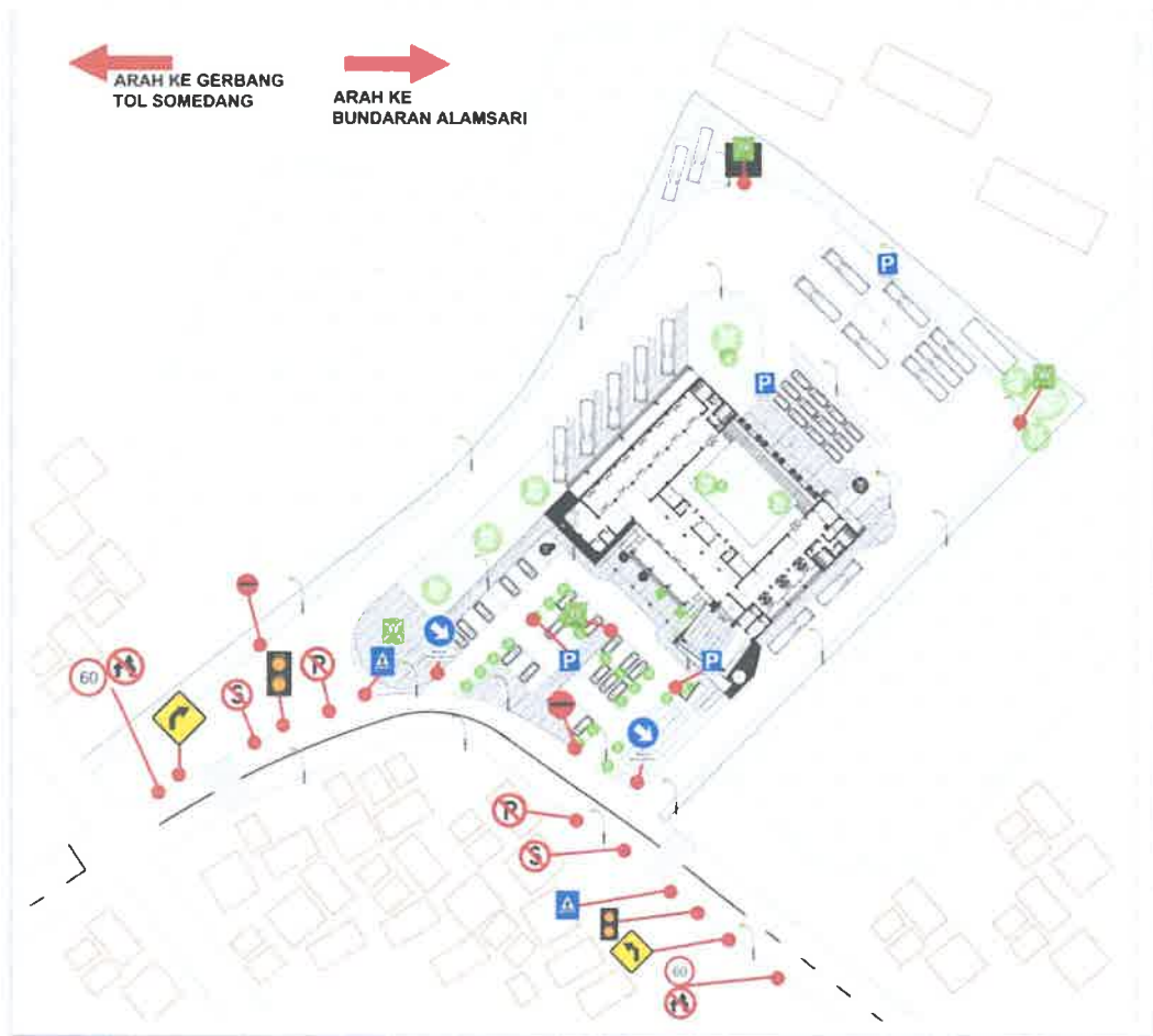
Gambar 5. 15 Fasilitas Perlengkapan Jalan pada Terminal Tipe A Ciakar
