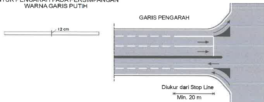
Gambar 2. 11 Standar Pemasangan Marka
